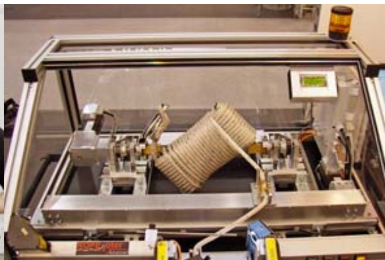
Abb. 2: Der vorgestellte Prototyp des Wicklungsautomaten mit Diagonalachsenwicklung. Foto: Anke Kahl
