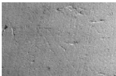
REM-Aufnahme einer geschliffenen (C120) Gesteinsoberfläche (Granodiorit aus dem Harz). Bildbreite ca. 2,3 mm
