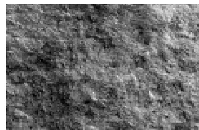
REM-Aufnahme einer gesandstrahlten Gesteinsoberfläche (Granodiorit aus dem Harz). Bildbreite ca. 2,3 mm
